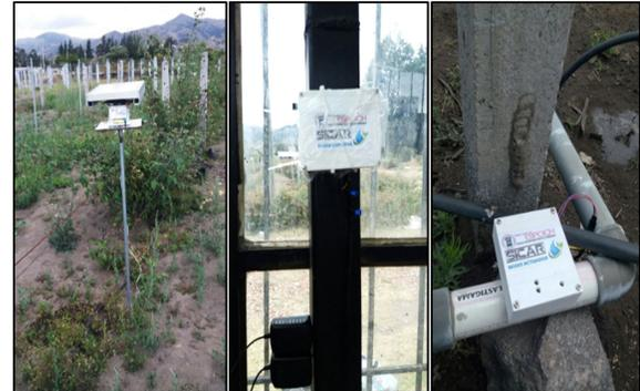
Figura 7. Prototipo del nodo sensor (izquierda), nodo control (centro) y nodo actuador (derecha).
