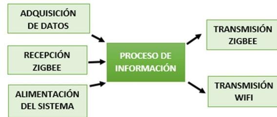
Figura 3. Diagrama de bloques del nodo actuador.
