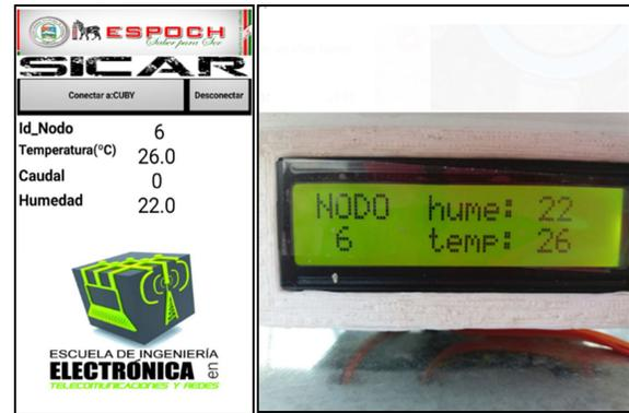
Figura 11. Monitoreo en la aplicación móvil (izquierda) y visualización en el nodo sensor (derecha).
