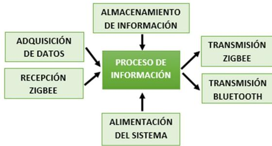
Figura 4. Diagrama de bloques del nodo control.
