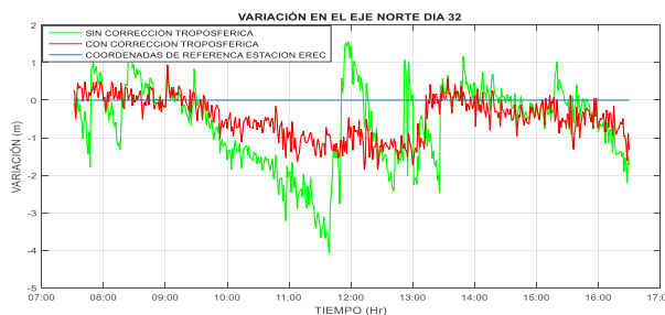
Fig. 8. Variación del Error de Retardo Troposférico en el Eje Norte correspondiente al día 32.
