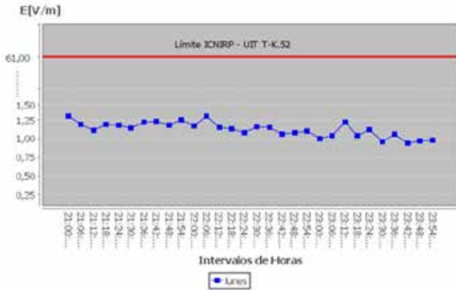
Fig. 2. Cuadro comparativo con las normativas ICNIRP y UIT T-K.52 del valor máximo, mínimo y medio de campo eléctrico del rango de 21:00 a 23:54 del día lunes.
