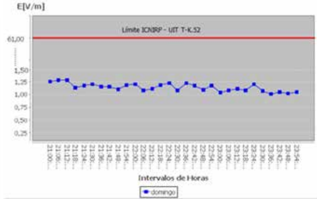
Fig. 8. Cuadro comparativo con las normativas ICNIRP y UIT T-K.52 del valor máximo, mínimo y medio de campo eléctrico del rango de 21:00 a 23:54 del día sábado.
