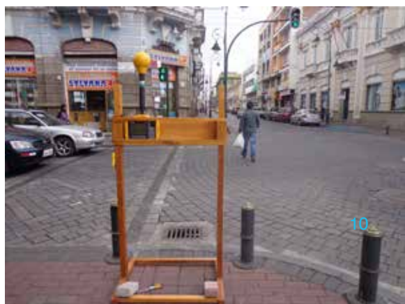
Figura 3. Equipo Narda SRM-3000 en el soporte de madera que simula a Duke, ubicado en el nodo 15, en las calles Primera Constituyente y Espejo.
