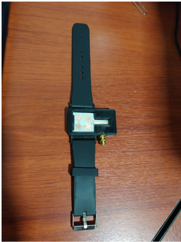
Figura 16. Prototipo de estructura de smartwatch con la antena implementada.
